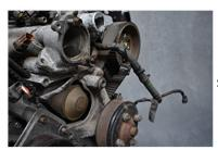
STEP 3: REMOVE THE PULLEY TO EXPOSE THE STEEL INSERT FITTED TO THE BLOCK..
