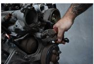
STEP 4: USING SOME GRIPS CLAMP ONTO THE INSERT AND ROTATE IT BACK AND FORTH. GRADUALLY THE INSERT WILL START TO WORK IT'S WAY FREE FROM THE BLOCK.
